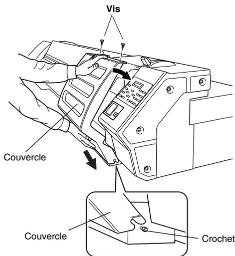
Veillez à ce que le couvercle soit correctement monté sur les crochets.
