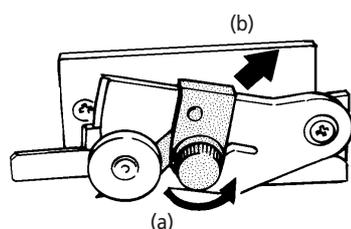
**Attention:** Si la lame est tombée dans le chariot d'impression, retirez-la avec les pincettes incluses dans le kit de nettoyage fourni.
