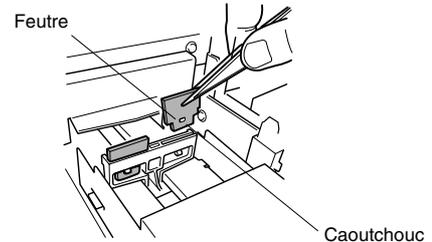
**Attention:** La raclette comporte une surface en caoutchouc et une surface en feutre. Installez-la en orientant sa surface en caoutchouc vers l'avant.
