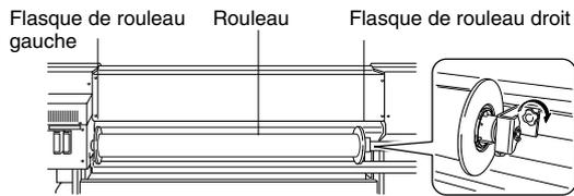
**Attention:** Lorsque le support en rouleau ploie considérablement, insérez la barre de renfort dans le rouleau. N'oubliez pas de retirer le tuyau de renfort du rouleau.
