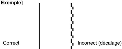
En cas de mauvais alignement (voyez l'illustration) quand vous imprimez en mode bidirectionnel, effectuez la correction requise avec le menu [BIDIRECTION]. (Voyez page 27.) Veillez à effectuer cette correction si vous changez de type de support ou s'il y a un décalage après un changement de hauteur des têtes d'impression.
