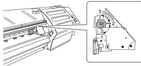
Dès que vous manipulez le levier, l'appareil émet un signal et l'écran affiche le nouveau réglage. Si vous avez placé le levier sur la position "1" (LOW), vous entendrez un signal. Si vous avez réglé le levier sur "2" (MIDDLE), l'appareil émettra deux signaux. Pour la position "3" (HIGH), l'appareil émet trois signaux.
