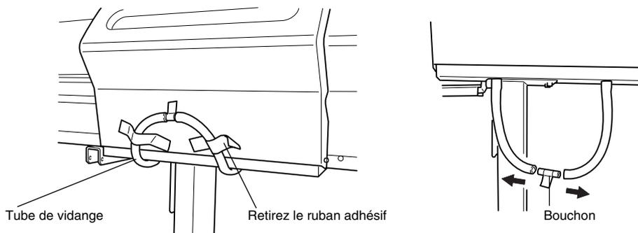
**Attention:** Soyez prudent quand vous retirez le bouchon du tuyau de vidange car il se pourrait que ce dernier contienne encore du liquide utilisé lors de l'inspection à l'usine.
