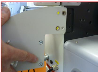
2. Installez à la place du support motorisé le support d'obturation, côté gauche lorsqu'on observe à partir de l'arrière de la machine.
