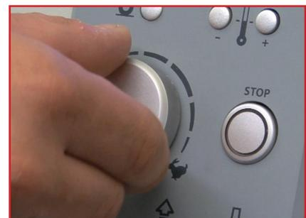
6. Vous pouvez modifier la vitesse de plastification de la machine en faisant tourner le bouton de commande de vitesse.
