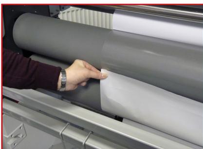
1. En suivant le schéma de chargement, faites passer le papier sur le rouleau inférieur et collez-le sur la partie adhésive du film adhésif.
