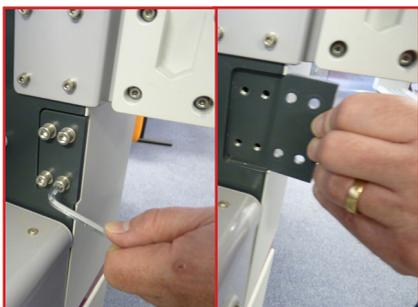
1. Pour l'installer, enlevez les plaques d'obturation à l'arrière de la machine.
