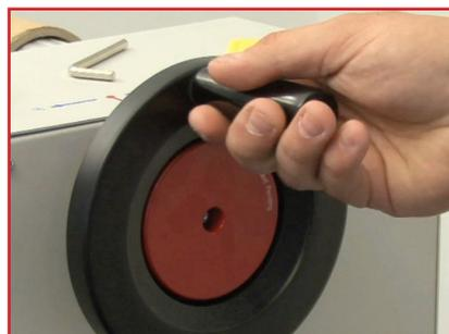
4. Abaissez les rouleaux jusqu'à la position neutre et serrez-les jusqu'à ce que vous sentiez une résistance ; vous êtes maintenant prêt à plastifier en mode continue (bobine à bobine).
