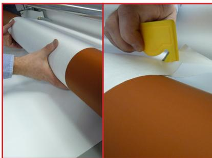
2. Placez le vinyle/imprimé entre les rouleaux du plateau alimentation sur la plaque arrière.
