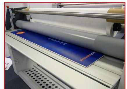
5. Appuyez sur le bouton drive (entraînement) et faites avancer. Nota lorsque le carton est entre les rouleaux, la poignée pression doit être ajustée pour compenser l'épaisseur.
