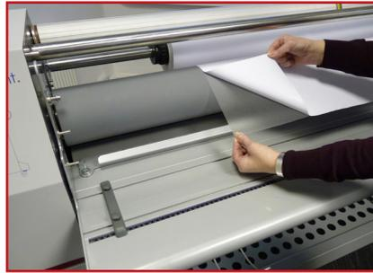
2. Décollez le liner du film, en exposant le côté adhésif du film et collez le pour tendre le mandrin en utilisant un ruban double face.
