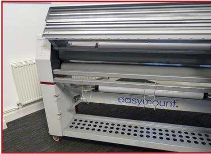
1. Soulevez le plateau d'alimentation en position verticale et verrouillez-le. En suivant le schéma de chargement sur le coffret gauche de la machine, tirez le film pour le faire passer en bas du mandrin et vers l'avant de la machine, pour aller au sommet du rouleau supérieur
