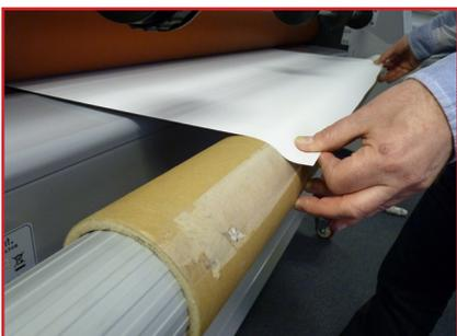
...les rouleaux étant soulevés, faites passer la feuille à travers la machine et fixez-la sur le rembobineur motorisé (option).
