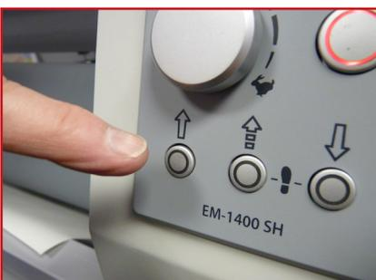
Le commutateur à pédale désactive l'œil magique, on recommande donc de démarrer lentement la machine en utilisant la pédale, et ensuite d'appuyer sur le bouton d'avancement continu lorsque la machine fonctionne.
