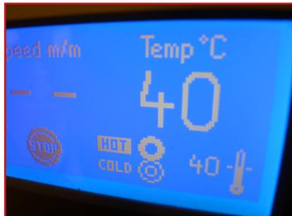
2. Réglez la température à environ 40 degrés en utilisant les boutons flèches vers le haut ou vers le bas. La température fixée et la température réelle sont affichées.
