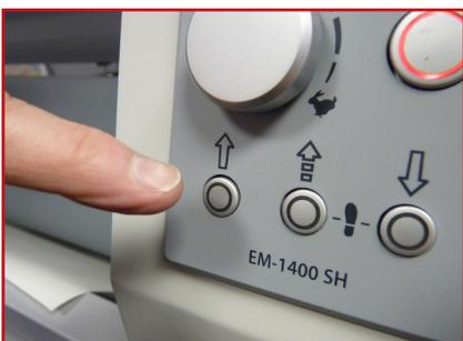
4. Pour démarrer la machine, appuyez soit sur le bouton d'entraînement (flèche à gauche) pour un entraînement continu, soit sur le bouton step (pas à pas) (flèche du milieu) pour la pédale de commutation. La pédale désactive l'œil magique, on recommande donc de démarrer la machine et d'appuyer sur le bouton d'entraînement continu lorsqu'elle fonctionne.
