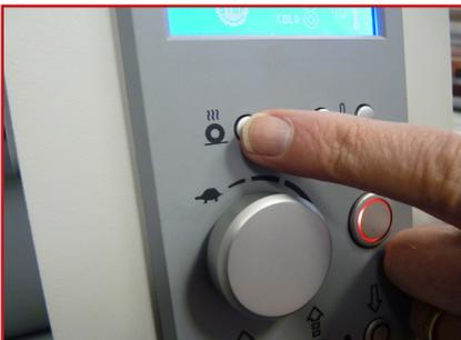
1. Le laminateur Easymount peut fonctionner à chaud ou à froid, pour commuter entre ces deux modes, appuyer sur le bouton du rouleau chaud sur le panneau de commande, l'affichage indiquera alors HOT (chaud) à côté de l'icône du rouleau supérieur.
