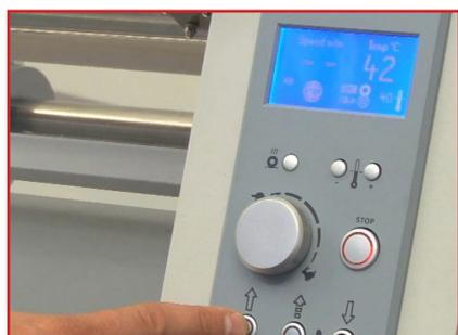
7. Appuyez sur le bouton d'entraînement forward (en avant). Le film et l'imprimé seront tirés à travers la machine.
