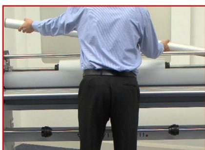
1. Le mandrin enrouleur est maintenu en place par une fixation à ressort : pour le détacher, appuyez sur le ressort et soulevez-le.
