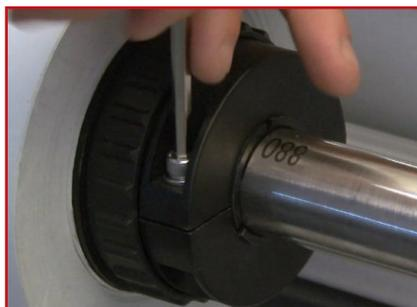
2. Dévissez les deux vis de fixation sur l'une des poignées de mandrin, retirez-le en le faisant coulisser d'un côté.
