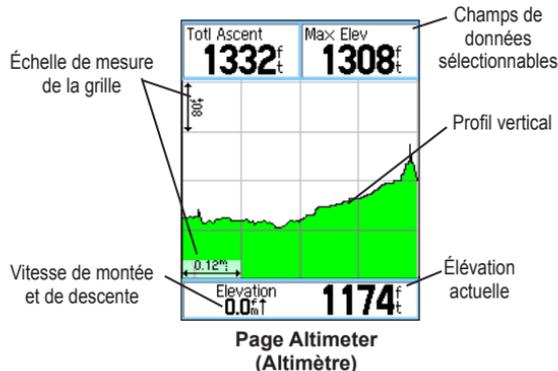
Le champ Status (État) au bas de la page montre l'élévation actuelle ainsi que votre vitesse de montée ou de descente actuelle lorsque vous êtes en mouvement. Il peut aussi montrer la pression ambiante et le temps de mesure.
