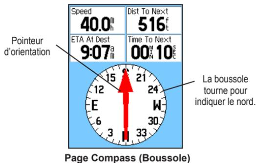
Pendant la navigation, la page Compass (Boussole) offre des données de navigation et des directions. Elle utilise le dessin d'une boussole, un pointeur d'orientation ou de parcours et des champs de données numériques pour donner des renseignements comme la vitesse actuelle, la distance jusqu'au prochain point d'itinéraire et l'heure d'arrivée approximative.
