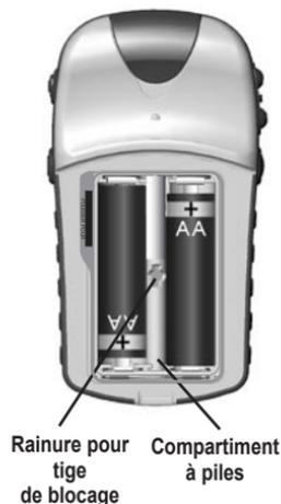
1. Retirez le couvercle du compartiment à piles en tournant l'anneau en D de 1/4 de tour dans le sens contraire aux aiguilles d'une montre puis en tirant sur le couvercle.
