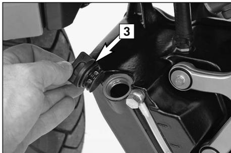
Enlever le bouchon [3]. Mettre 2,5 litres d'huile moteur synthétique selon la norme JASO MA (par exemple Motorex Power Synt 4T) et remettre le bouchon. Faire démarrer le moteur et le laisser chauffer au point mort jusqu'à atteindre la quatrième graduation sur la jauge de température. Couper le moteur et vérifier le niveau (voir Contrôle du niveau d'huile).
