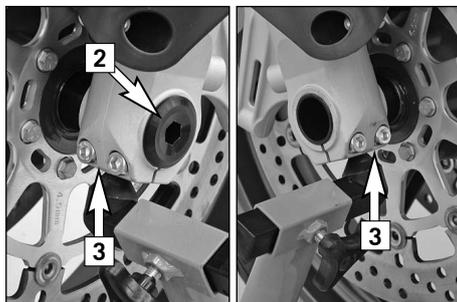
Desserrer la vis à épaulement [2] et les vis [3] au bas de la fourche. Desserrer la vis à épaulement d'environ 8 tours puis appuyer dessus avec la main de manière à faire sortir la broche. Retirer la vis. Maintenir la roue et sortir la broche. Dégager la roue de la fourche.
