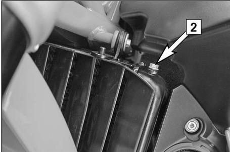
On remplit alors avec du liquide de refroidissement jusqu'à ce qu'il ressorte sans bulles d'air par l'orifice de purge. Remonter aussitôt la vis pour éviter que l'air rentre dans le radiateur.
