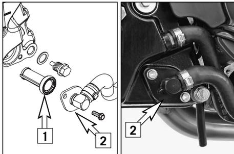
Monter le bouchon de vidange du réservoir d'huile avec un joint neuf. Serrer à 20 Nm.
