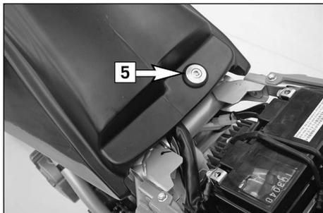
Déposer la selle et retirer la vis [5]. Fermer les robinets d'essence et débrancher la durite. Tirer le réservoir un peu vers l'arrière, le soulever d'environ 10 cm à l'avant et glisser dessous quelque chose sur quoi il prenne appui. Retirer la vis de purge [6] et le bouchon de radiateur.
