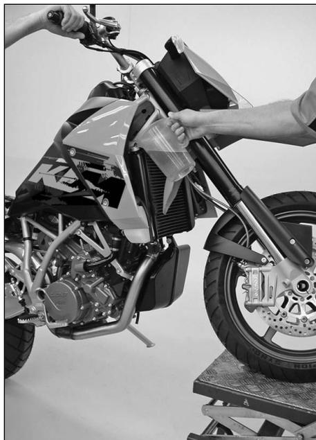
On remplit alors avec du liquide de refroidissement jusqu'à ce qu'il ressorte sans bulles d'air par l'orifice de purge. Remonter aussitôt la vis pour éviter que l'air rentre dans le radiateur.
