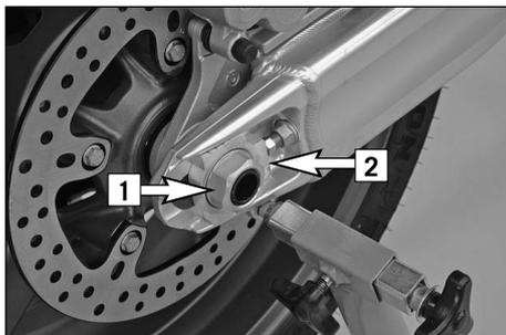
Enlever l'écrou à épaulement [1], retirer le tendeur de chaîne [2], maintenir la roue et retirer la broche [3]. Pousser la roue le plus possible vers l'avant de manière à pouvoir faire descendre la chaîne de la couronne. Sortir la roue du bras oscillant avec précaution.
