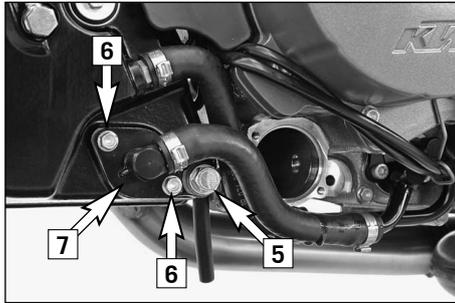
Retirer le bouchon de vidange [5] du réservoir d'huile et laisser l'huile s'écouler dans un récipient. Retirer les vis [6] et faire basculer le raccord [7] sur le côté.
