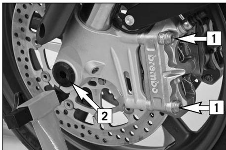
Retirer les vis [1] sur les pinces droite et gauche et dégager les pinces des disques avec précaution vers l'arrière.
