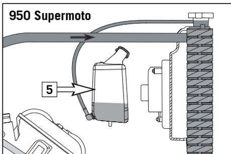
La surpression qui apparaît lorsque le liquide chauffe est réglée par un système de soupape dans le bouchon du radiateur [4]. On peut atteindre une température de 125°C sans gêner le fonctionnement.
