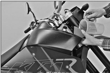
Finir de remplir le radiateur. Revisser le bouchon et remettre la moto à l'horizontale. Remplir le vase d'expansion de liquide de refroidissement jusqu'à ce que le niveau se situe entre les repères MIN et MAX. Fermer le vase d'expansion.
