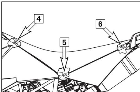
Pour monter la selle, l'accrocher à la vis à tête bombée [4], l'abaisser à l'arrière et pousser en même temps vers l'avant. Les deux pattes [5] doivent s'accrocher sur le cadre. Enfiler le doigt de la serrure [6] dans le logement et appuyer sur l'arrière de la selle jusqu'à ce qu'on entende que le doigt a pris sa place.
