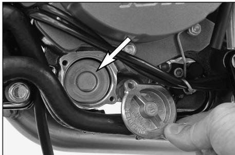
Enfiler un filtre à huile neuf dans le carter. Graisser le joint torique et monter le couvercle avec le joint. Serrer les vis à 6 Nm.
