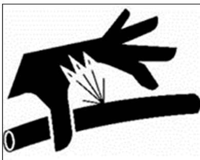
Illust. 4: Risque de blessure en raison d'une fuite d'huile hydraulique.
