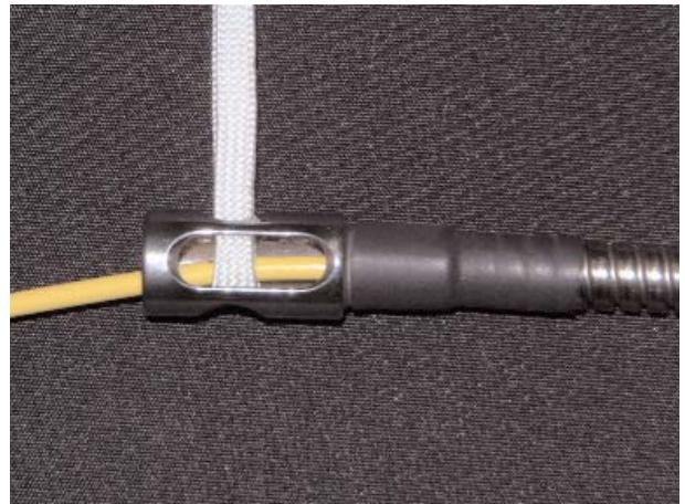
Passage de la boucle dans l'oeillet de l'élévateur.
