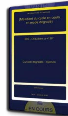
**PRECIJET VOUS ALERTE** en cas d'anomalie constatée et bascule automatiquement en mode alternatif, tout en indiquant l'origine du défaut
