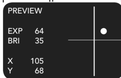
La moitié droite de l'écran affiche l'image que le capteur d'image interne détecte. Les étoiles sont représentées par des points. Plus l'étoile est lumineuse, plus le point est gros.
