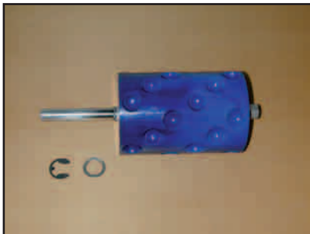
Remplacement du rotor
