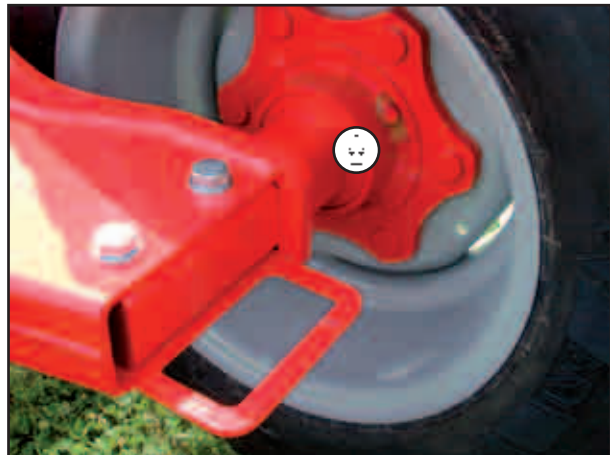
Points de graissage : Moyeu de roue de support et train de roulement
