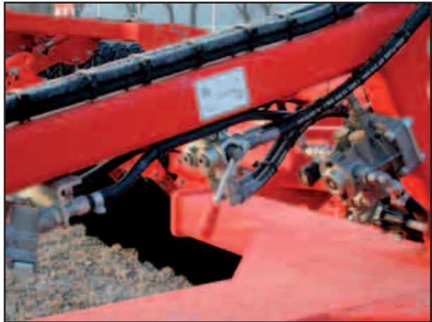
Robinet d'arrêt pour le réglage de profondeur de packer
