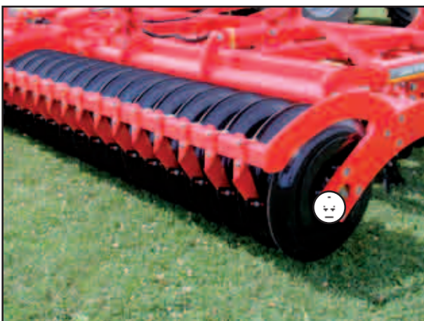
Points de graissage : Paliers du packer
