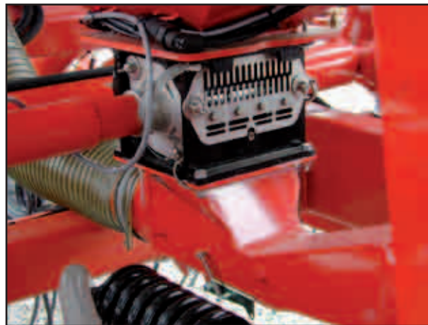
Appareil de dosage avec couvercle pour la buse d'injection
