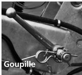
Levier avec goupille et détail du trou réservé à la goupille
