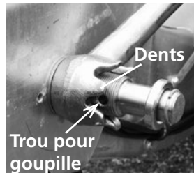
Levier avec goupille et détail du trou réservé à la goupille
