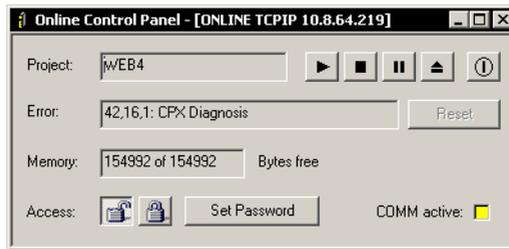
Fig. 3/22 : Informations de diagnostic codées dans le pupitre de commande en ligne du FST
