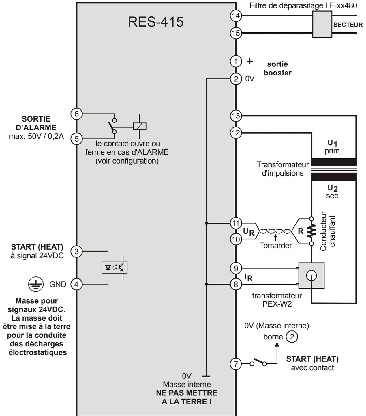
**4.7 Schéma électrique avec connexion booster**
