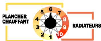
Pour le mode **Radiateur** (ou Radiateur + Chauffage au sol), il est conseillé de régler le commutateur rotatif sur les chiffres 6 à 10. La température définie augmente en fonction de la position choisie (6 à 10).
