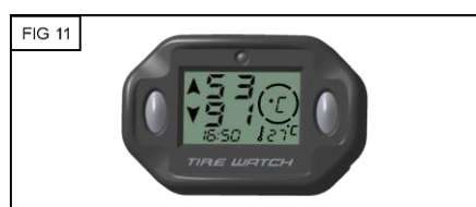
FIG 11 – ALERTE FRANCHISSEMENT SEUIL DE TEMPERATURE
