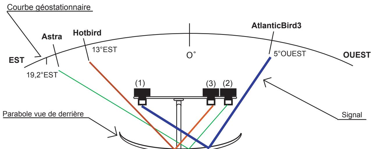
Vous pouvez remarquer que le signal est réfléchi sur la parabole pour l'amener sur la tête opposée à la position du satellite.
