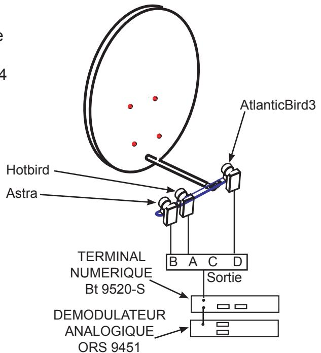
**Commutateur DiSEqC :** C'est ce boîtier qui permet de basculer entre les chaînes du satellite Astra et celles du satellite Hotbird. (Et même ATB3 dans le cas de l'installation N°2)
