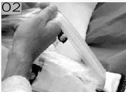
Vous pouvez également enduire le boudin de talc afin de faciliter le remplacement du boudin dans le bord d'attaque.
