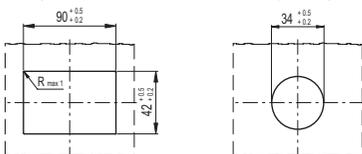
La surface de montage doit être plane. Les gondolages ou les bosses
