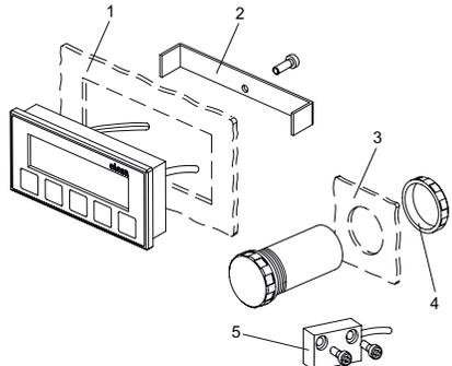
5) Fixer le capteur magnétique en utilisant des vis M3 (pas comprises dans la fourniture). Distance entre le capteur et la bande magnétique pour assurer une lecture correcte du déplacement: max 2,5 mm.
