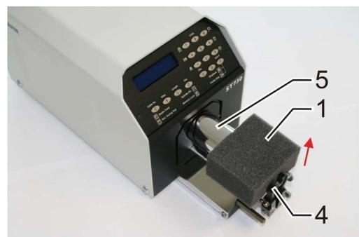
Figure 3. Enlever le capot de protection / mettre la machine en position
