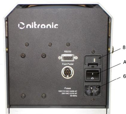
Figure 4. Activer l'interrupteur principal
