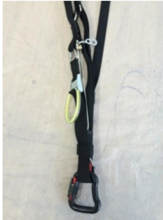
Les 2 trims séparés et montés sur l'élévateur
