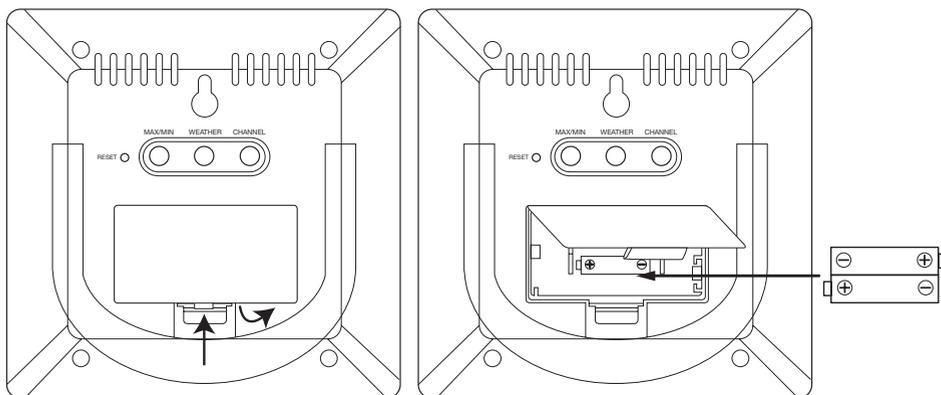
Insérer 2 piles AA/LR O6 en respectant les indications (+) et (-) de polarité inscrites dans le compartiment des piles.
