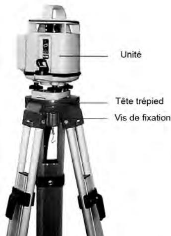
Ajustez les trois vis pour placer la bulle au centre de la fiole.
