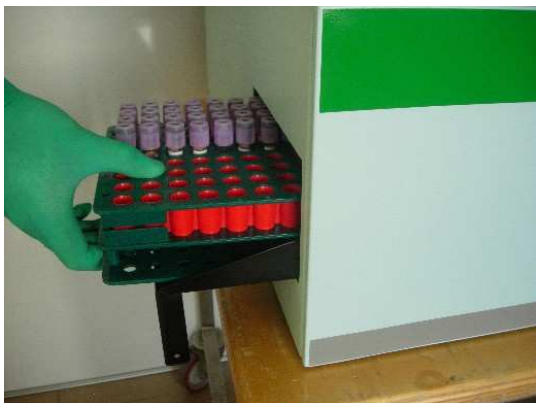
fig. 2.2.2 côté gauche du Ves-Matic Cube 80 (Rack porte-échantillons à la sortie)
