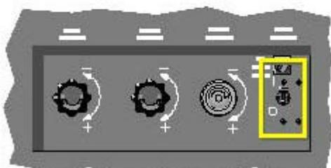
Le disjoncteur principal permet d'alimenter ou non les composants électriques internes de la source d'alimentation.
