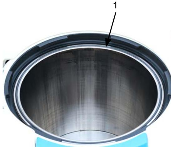
Figure 9 - Échange du joint de couvercle
