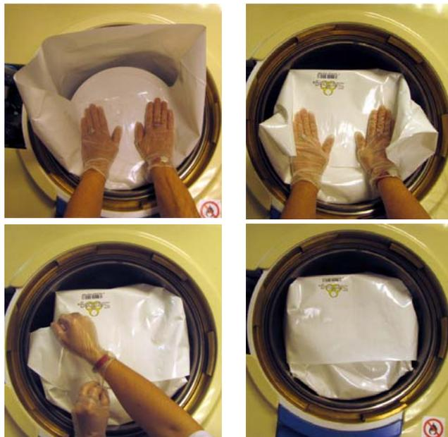
3) Replier vers le bas de part et d'autre du sac le long du fut les pointes provoquées par les pliages.
