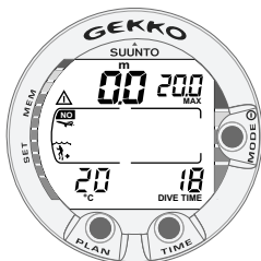
Fig. 3.26. Affichage en surface. Vous avez fait surface après une immersion de 18 minutes à la profondeur maximale de 20.0 m [66 ft]. La profondeur instantanée est de 0.0 m [0 ft]. Le voyant en forme d'avion vous indique l'interdiction de vol et le voyant attention que vous devez prolonger votre intervalle surface à cause du niveau de micro bulles.
