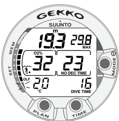
Fig. 3.22. Plongée nitrox. L'02% est réglé à 32%.
