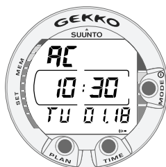
Fig. 2.4. L'abréviation AC indique que les contacts sont actifs.
