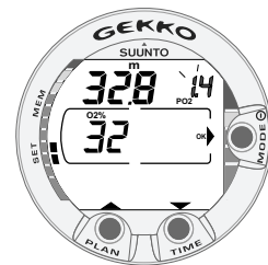
Fig. 4.17. Réglage des paramètres Nitrox. Le pourcentage d'oxygène est de 32% et la pression partielle est de 1.4 bars. La profondeur maximale équivalente est de 32.8 m [107 ft]. Pour changer la valeur d'oxygène et de pression partielle, appuyez sur les boutons de défilement. Validez les valeurs en appuyant sur le bouton Mode (OK).
