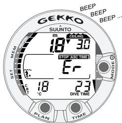
Fig. 3.18. Plongée avec paliers de décompression, au-dessus de la profondeur plafond. La flèche vers le bas apparaît et l'alarme sonore apparaît. L'alarme sonore se déclenche également. Vous devez immédiatement redescendre (dans les 3 minutes) à la profondeur plafond ou plus bas.
