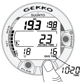
Fig. 3.7. Affichage en plongée. La profondeur est de 19,3 m, le temps de plongée sans palier est de 23 minutes en mode A0/P1. La profondeur maximale de la plongée est de 19,8 m, la température de l'eau est de 18°C, le temps d'immersion est de 16 minutes. En appuyant sur le bouton TIME, l'heure s'affiche pendant 5 secondes.
