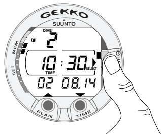
Fig. 4.10. Carnet de plongée, page I. Appuyez sur le bouton "CLÉ" SELECT, pour faire défiler les autres plongées.
