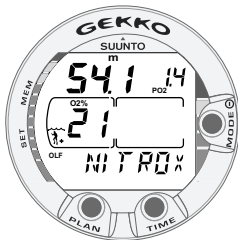
Fig. 3.20. Affichage nitrox. La profondeur maximale basée sur des réglages 02% (21%) et PO2 (1.4 bar) est de 54.1 m [177 ft].
