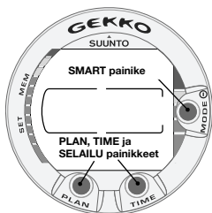
Fig. 2.2. Les boutons-poussoirs de l'ordinateur.
