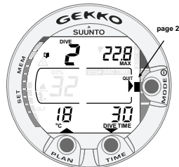
Fig. 4.7. Carnet de plongée, page II. Paramètres principaux de la plongée.
