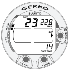
Fig. 4.13. Paramètres de la Mémoire Historique. Nombre total de plongées, nombre d'heures et profondeur maximale.
