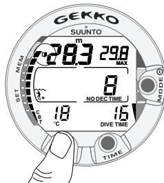
Fig. 3.8 Marquage activé. Le repère est placé sur un point du profil de la plongée en appuyant sur le bouton PLAN. Le symbole du carnet de plongée s'affiche au moment où vous appuyez.
