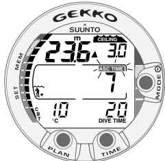
Fig. 3.15. Plongée avec paliers de décompression en dessous de la profondeur plancher. La flèche pointant vers le haut, la mention ASC TIME clignotante et l'alarme sonore vous recommandent de remonter. La durée totale de remontée minimale incluant le palier de sécurité est de 7 min. La profondeur plafond est à 3 m [10 ft].
