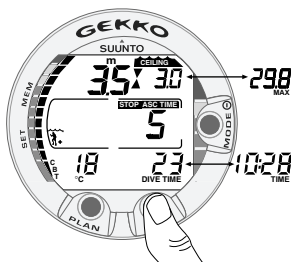
Fig. 3.17 Plongée avec paliers de décompression dans la zone de décompression. Les deux flèches se font face. Vous êtes dans la zone de décompression optimum à 3.5 m [11 ft] et la durée totale de remontée minimum est de 5 minutes. En appuyant sur le bouton TIME, l'heure et la profondeur maximale s'affichent.
