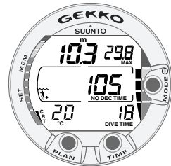
Fig. 3.11. Indicateur de vitesse de remontée. Vitesse maximale autorisée. Quatre segments.
