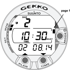
Fig. 4.6. Carnet de plongée, page I. Défilement des différentes pages d'une plongée.
