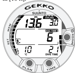
Fig. 3.16. Plongée avec paliers de décompression au-dessus de la profondeur plancher. La flèche a disparu et la mention ASC TIME ne clignote plus. Vous êtes dans la zone de décompression.
