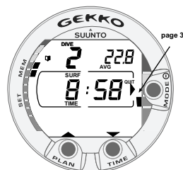
Fig. 4.8. Carnet de plongée, page III. Intervalle surface, profondeur moyenne.
