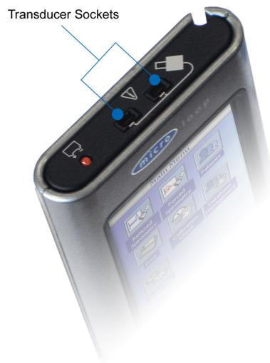
Veillez vous assurer que la turbine est connectée dans un des 2 ports au dessus de l'appareil.
