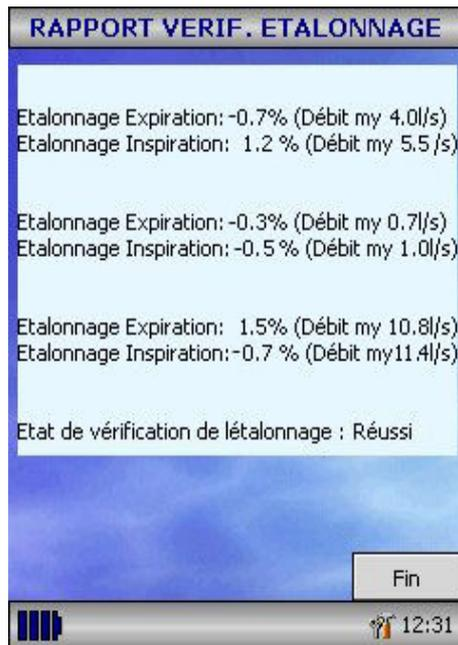
L'erreur d'étalonnage pour l'inspiration et l'expiration à chaque niveau de débit est affichée. Cette erreur doit être de moins de 3%. Si une erreur plus importante apparaît, répétez la manœuvre en vous assurant que la seringue est vidée et remplie de façon constante sans cogner les extrémités. Si une erreur de plus de 3% persiste, inspectez la turbine et nettoyez la si nécessaire.
