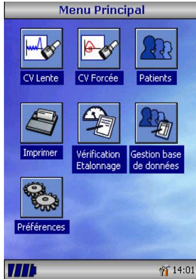
Le MicroLoop utilise un écran tactile sur lequel les icônes représentent les diverses fonctions. Un stylet, placé sur la gauche de l'appareil, permettra d'activer les icônes.
