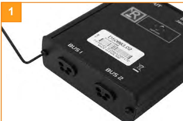
A l'aide d'une clé hexagonale de 1,5 mm, retirez les vis de la plaque frontale du connecteur.
