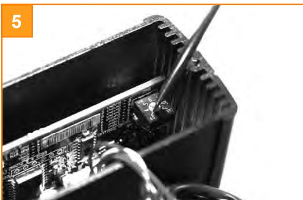
Réglez le commutateur à la position désirée à l'aide d'un petit tournevis plat. Remplacez la plaque frontale.
