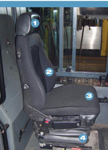
Les principaux éléments d'un siège pour chauffeur d'autobus.
