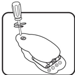
3. Insérer 4 piles LR6/AA en respectant le schéma qui se trouve dans le compartiment à piles.
