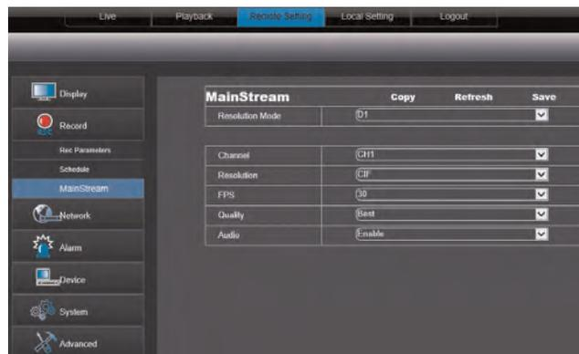
2. Dans **Mode résolution**, sélectionner **D1** ou **960H**. Si le réglage du mode de résolution est changé, le système redémarrera une fois que les modifications seront sauvegardées.
