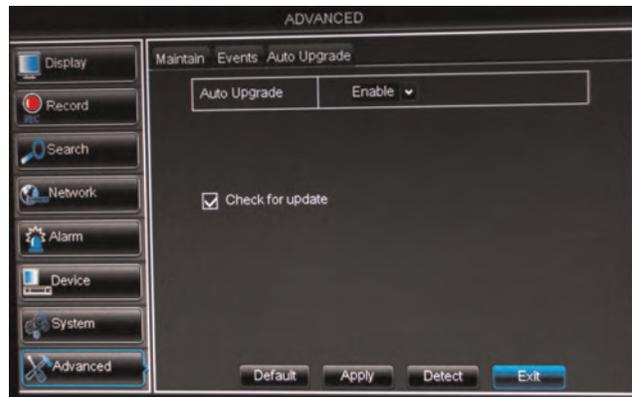
2. Dans **Mise à jour automatique**, sélectionner **Activer** pour activer les mises à jour automatiques du microprogramme. Les messages de mises à jour du microprogramme apparaîtront sur le DVR ainsi que sur le logiciel client.
