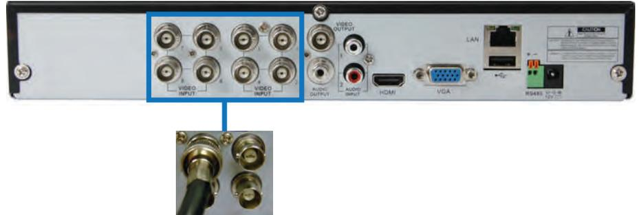
Pousser et tourner le connecteur BNC en direction horaire pour le fixer dans le port BNC
