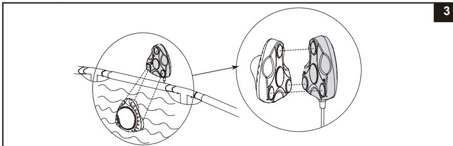
3. Ajustez manuellement la position de la lampe en faisant glisser l'émetteur.
