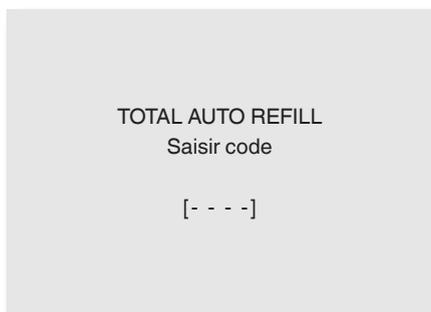
En saisissant le "code refill" (par défaut 1234), les compteurs sont mis à zéro et l'appareil se met en fonctionnement normal.
