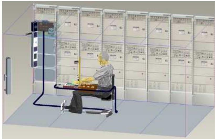
*DEX avec une personne-test dans l'ISS, les bandes verticales constituant le dispositif capteur du système de détermination de position 3D.*
