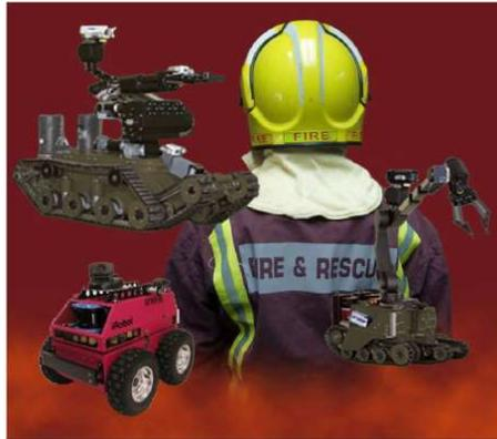
L'objectif du projet VIEWFINDER consiste dans le développement de robots dont la première tâche réside dans la collecte de données. Ces robots sont équipés d'un certain nombre de capteurs qui détectent la présence de produits chimiques ainsi que d'un dispositif visionique qui procède parallèlement à la collecte de données image et à leur transmission à une station de base évoluée.
