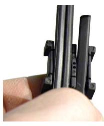
Mettre ensuite la partie supérieure du connecteur sur la partie inférieur, en vous assurant que les fils sont bien à plat.
