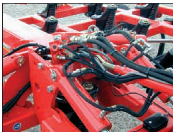
Barre de poussée hydraulique, fiche pour le DrillManager et les fonctions hydrauliques
