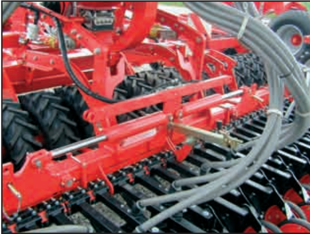
Dispositif de sécurité du repliage (position de travail)
