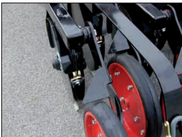
Décrotteur, disques de coudre et roues plumbeuses
