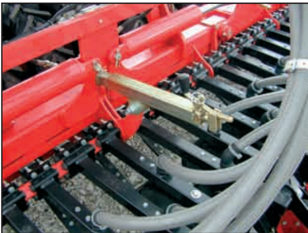
Manivelle de réglage de pression sur les socs
