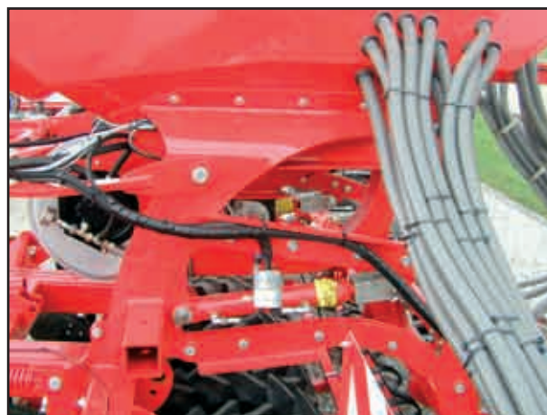
Vérin hydraulique sur le train de roulement
