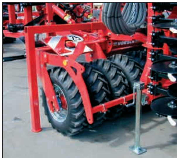
Béquilles de stationnement devant et derrière
