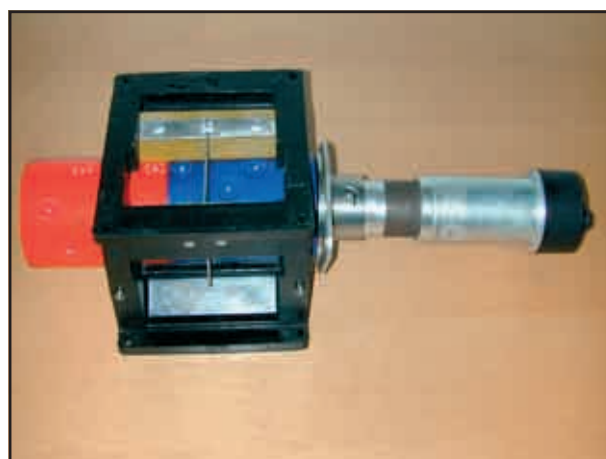
Echange du rotor avec une trémie pleine
