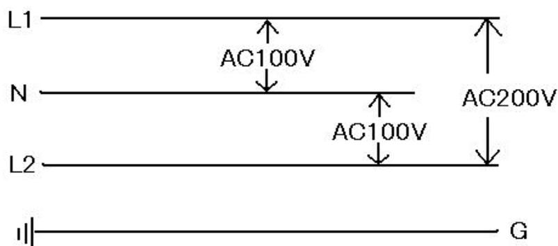
Illustration: conditions de réseau nécessaires pour S 450 H / S 900 H en réseau électrique 100 V et 115 V.
