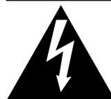
Le symbole de l'éclair dans un triangle équilatéral indique la présence d'une tension suffisamment élevée pour engendrer un risque de chocs électriques.
