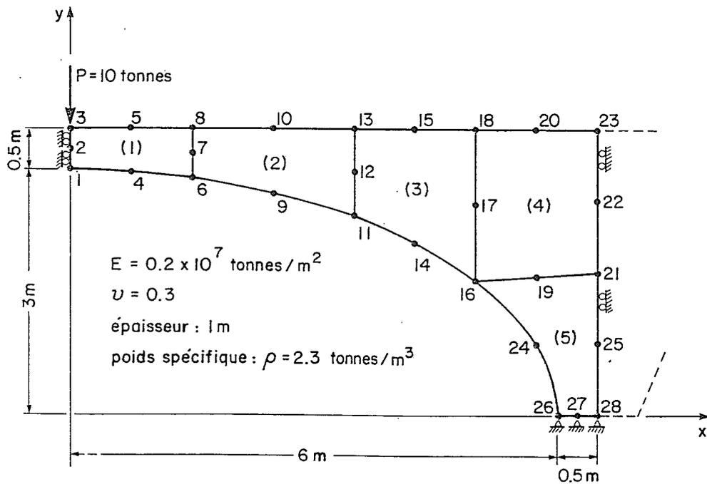
Les sollicitations sont constituées par une force concentrée de 10 tonnes. On a utilisé des éléments isoparamétriques à 8 noeuds du type 6 (voir manuel d'utilisation).
