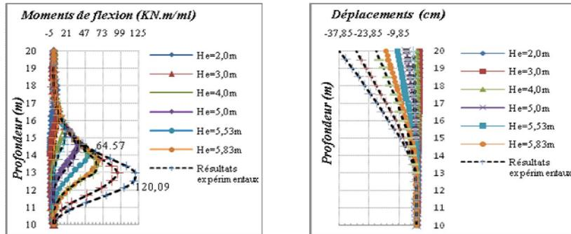
a)-Profils des moments de flexion      b)-Profils de déplacements horizontaux
