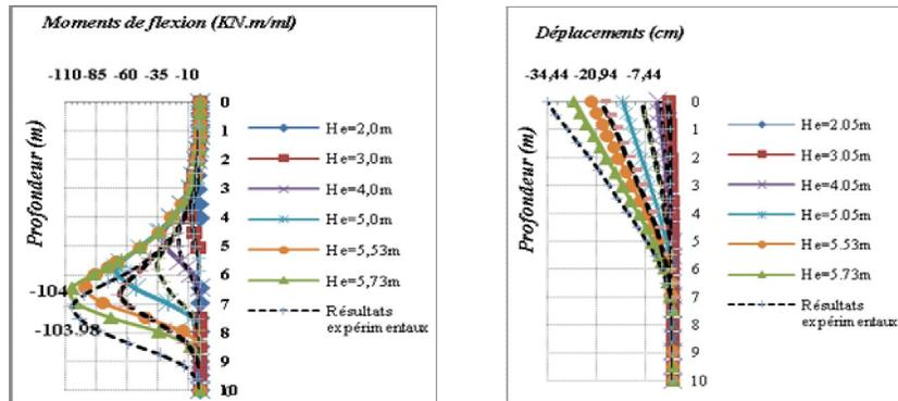
a)-Profils des moments de flexion      b)-Profils des déplacements horizontaux
