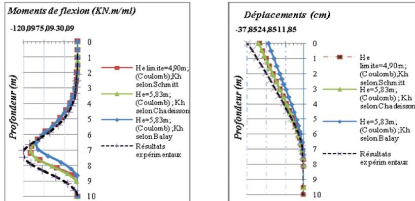
a)-Profils des moments de flexion      b)-Profils des déplacements horizontaux
