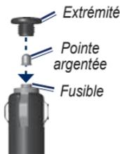
2. Retirez le fusible (cylindre en verre et en argent) et remplacez-le par le type de fusible qui convient, indiqué sur le côté de l'adaptateur du véhicule.
