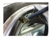
Monter le raccord de pompe sur la valve. Veillez à ce qu'il y ait une bonne connexion.
