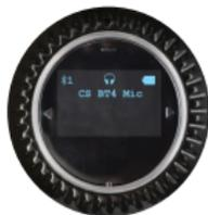
**ASTUCE :** Le micro QT4 doit être à moins de 10 mètres du Quattro 4.0 pour fonctionner correctement.
