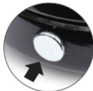
**ÉTAPE 2 :** Jumeler et connecter rapidement le micro QT4 : Appuyez sur le BMM (sur le micro) jusqu'à ce que le voyant lumineux clignote en rouge et bleu.
