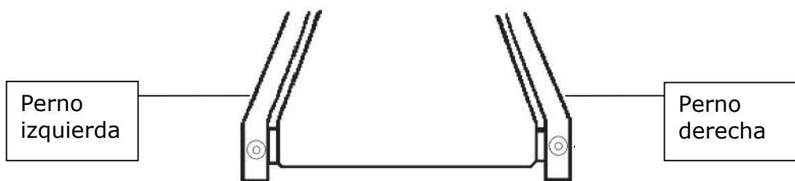
Apriete el rodillo trasero bastante para evitar que el rodillo delantero deslice. Gire los 2 pernos en el sentido de las agujas del reloj y verifique la tensión de la banda. Haga cuidado a apretar de modo equivalente el perno de derecha y el de la izquierda para no descentrar la banda de carrera.
