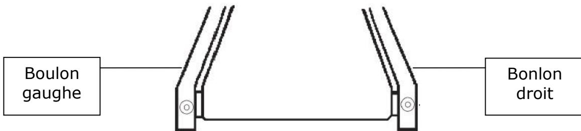
**Note: Le réglage se fait par les boulons situés à l'extrême du tapis.**
