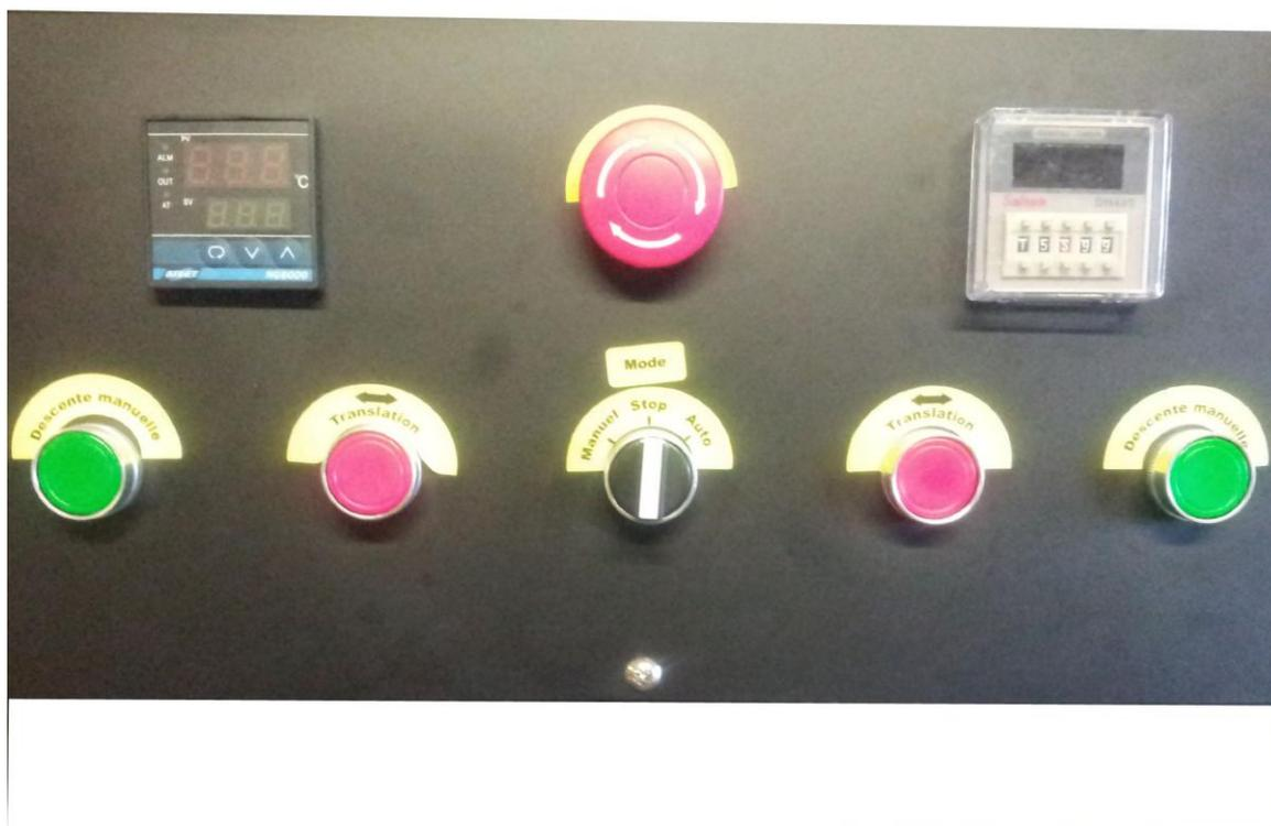
**A** – Mettre le bouton sélecteur de mode sur la position << **Manuel**>>, appuyez sur l'un des boutons poussoirs rouges pour que le plateau inférieur se déplace à gauche ou à droite sous le plateau chauffant.
