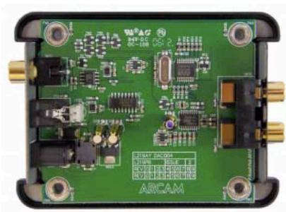
Le circuit dispose d'un aiguillage entre les entrées numériques coaxiale et optique (inaccessible ici), cette dernière étant surmontée d'une LED bicolore (rouge : module sous tension, verte : présence d'un signal numérique).
