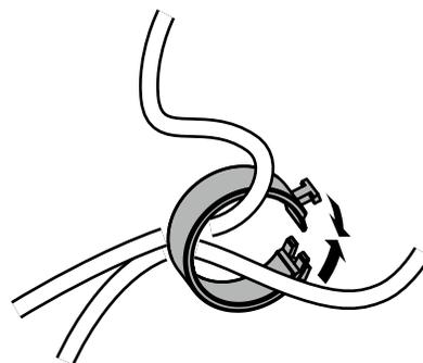
3. Maintenez le serre-câbles fermé et insérez-le dans le socle.
