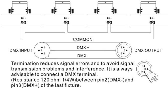
1. Sur le dernier appareil, le câble DMX doit avoir un bouchon de terminaison afin de réduire les défauts du signal. Il faut alors souder une résistance de 120 Ohm 1/4W entre la borne 2 (DMX-) et la borne 3 (DMX+) dans une prise XLR 3 points. Raccordez-la à la sortie DMX du dernier appareil
