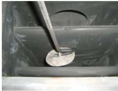
Enlever le couvercle du fond avec un crochet
