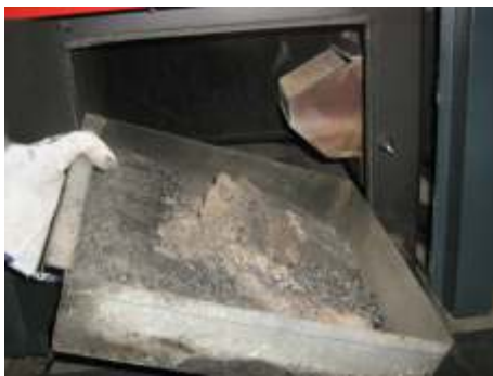
Enlever le cendrier, Le nettoyer, et le remettre à sa place
