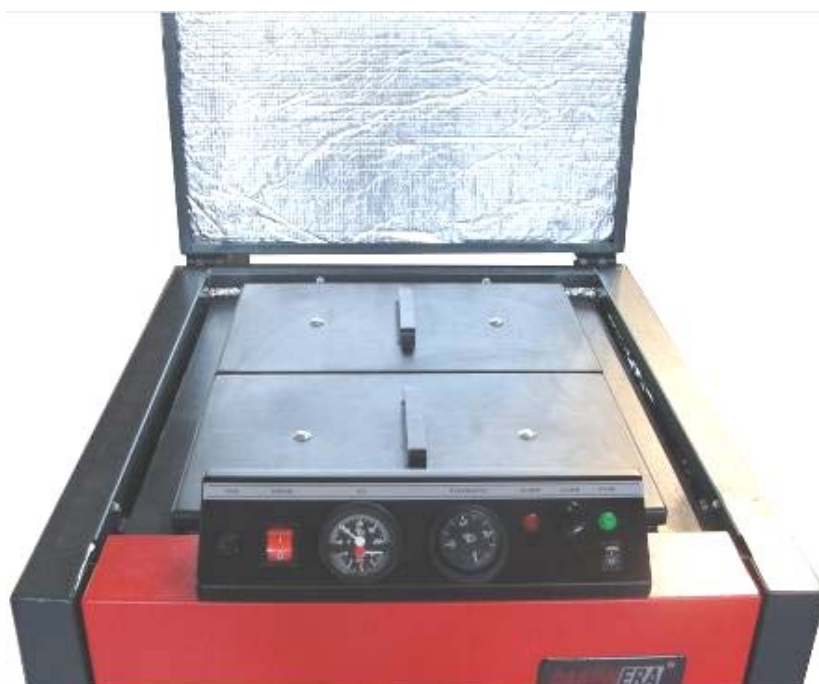
Figure 4.11. Les deux couvercles des fumées sont mis à leur place dans l'échangeur de chaleur de la chaudière.
