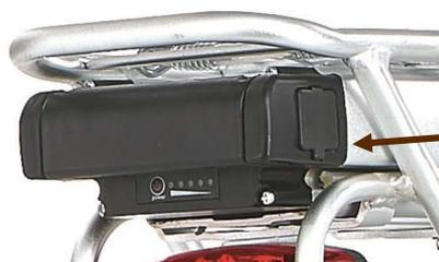
**Brancher d'abord la prise du chargeur sur la batterie puis sur le secteur.**
