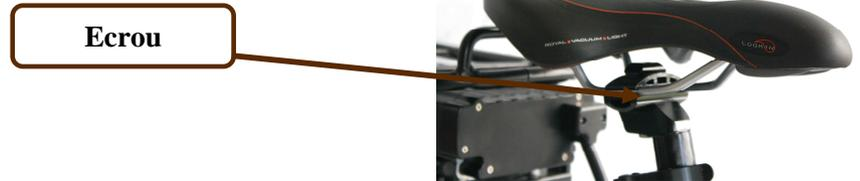
Régler l'inclinaison de la selle, afin d'obtenir la position la mieux adaptée à votre confort. Resserrer l'écrou, couple de serrage maxi 13 Nm.
