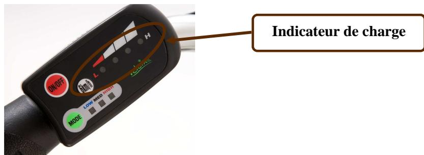
A chaque action de mise en alimentation (NB : clé de contact de la batterie sur « ON ») les voyants s'allument successivement pour un test de lecture, et se stabilisent après. Située sur le guidon côté gauche, l'ensemble jauge/sélecteur est à portée de votre vue. Au départ, avec une batterie chargée, tous les points sont au rouge. Vous pouvez ainsi contrôler l'énergie restante et adapter votre allure et votre mode d'assistance.
