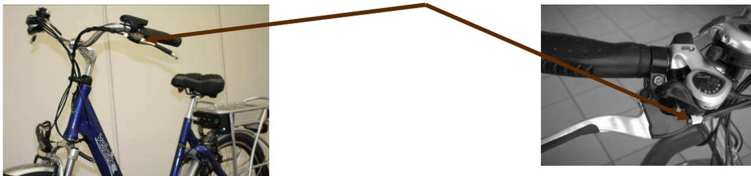
Desserrer le serre-câble et tirer sur le câble jusqu'à ce que les patins touchent la jante. Resserrer le serre-câble (une attention particulière est à apporter à chaque extrémité de la gaine qui doit entrer sans forcer dans le logement de chaque embout rigide, côté poignée de frein et V Brake.)
