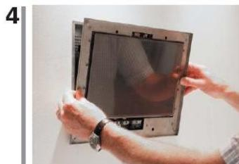
Utilisez un tournevis aimanté et introduire les vis de fixation de la partie supérieure
